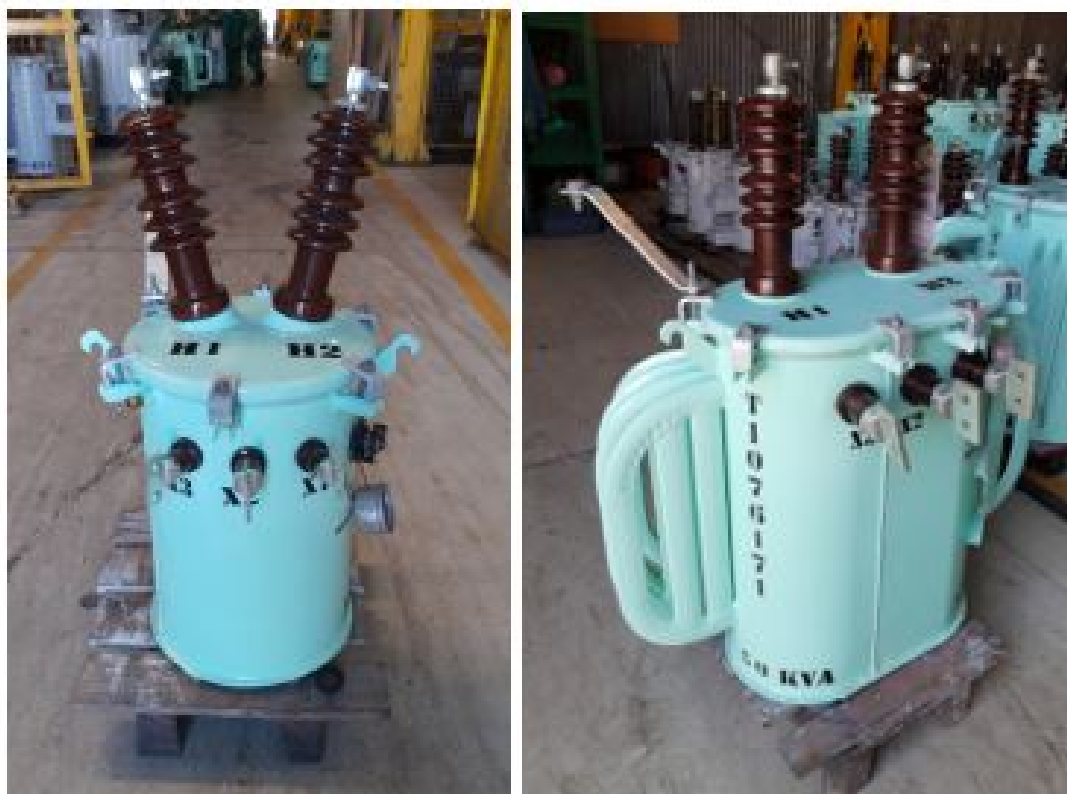
Figura 2 - Transformadores de 10 e 50 kVA monofásico reformados
